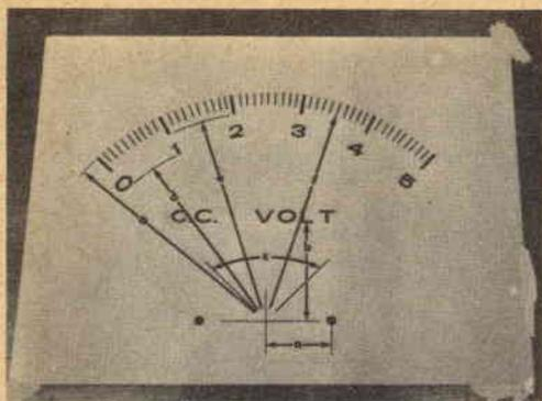
**Fig. 1 - Misurate accuratamente sul quadrante originale dello strumento le dimensioni a, b, c, d, e, f, g, e poi moltiplicatele per 5. Tutte le misure si effettuano in centimetri tranne l'angolo c che si misura in gradi con un rapportatore di precisione.**
