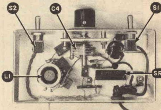
**Tutti i componenti che generano più calore sono montati nella parte superiore del telaio; i componenti relativi al controllo di frequenza sono posti nella parte inferiore.**
