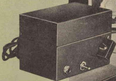
L'intero trasmettitore è montato in uno schedarietto. Notate la disposizione orizzontale dell'unico tubo usato.
