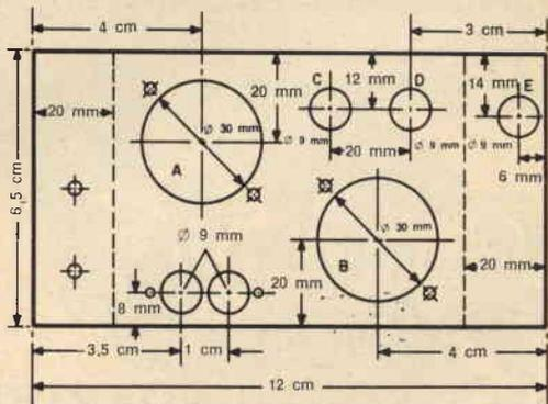
Fig. 1 - Piano di foratura del telaio.
