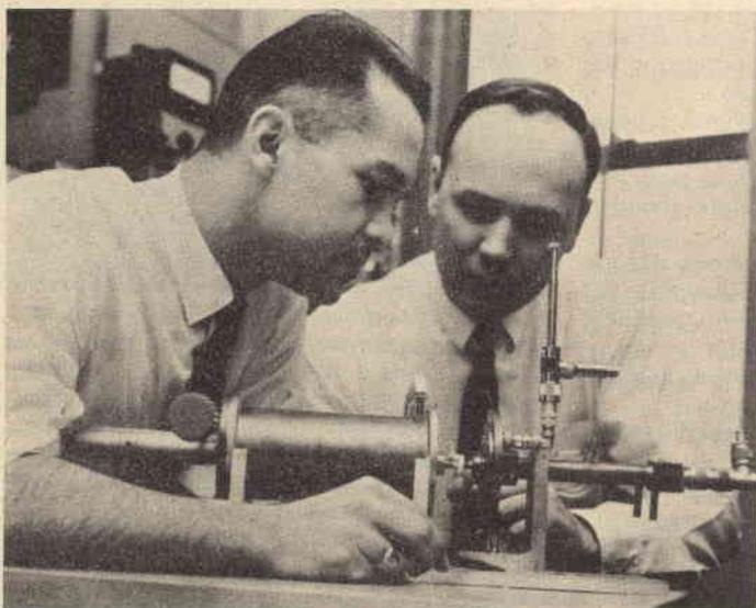
Oscillazioni continue a microonde di sostanziale potenza sono state ottenute, per la prima volta, in un dispositivo semiconduttore all'arseniato di gallio dal dr. Basil W. Hakki (a sinistra) e dal dr. John C. Irvin (a destra), dei laboratori della Bell Telephone. Nella foto, i due scienziati esaminano la cavità a microonde, che è stata appositamente progettata, nella quale è racchiuso il semiconduttore quando è in funzionamento.
