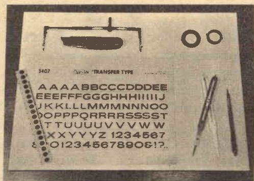
**I materiali necessari per disegnare un quadrante sono un foglio di lettere e numeri già stampati, un compasso ad asta, punti da 3 mm, nastro adesivo da 3 mm e 1,5 mm, ed un cartoncino da disegno.**
