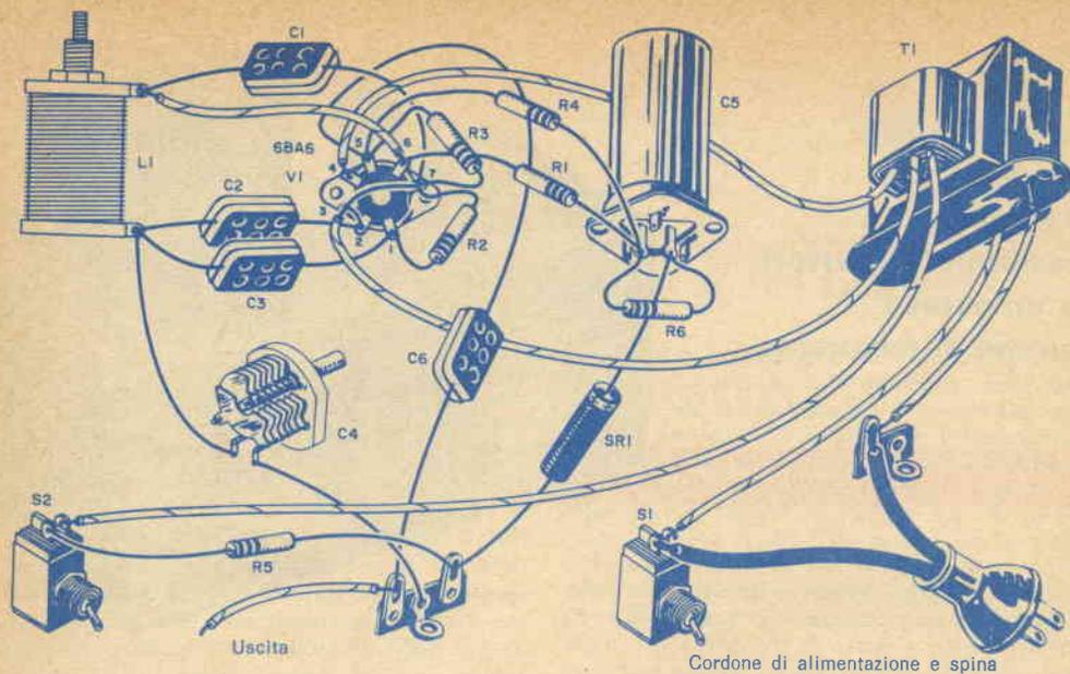
Seguite la vista esplosa ed il circuito elettrico per effettuare il montaggio. C5 è messo a massa attraverso il suo involucro metallico.
