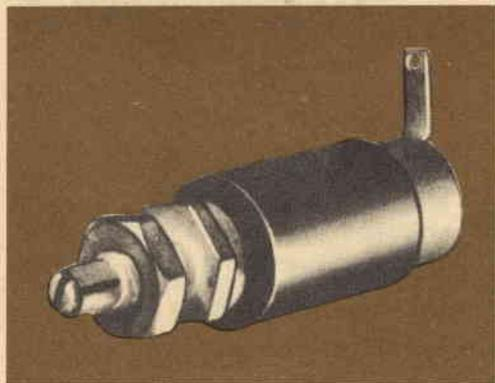
Il Tefotrim Stile 518 (*fig. 1*) ha capacità variabile fra 0,8 pF e 18 pF, lo Stile 330 (*fig. 2*) fra 2 pF e 30 pF, lo Stile 408L fra 0,25 pF e 8 pF. Quest'ultimo, che ha un diametro di 5 mm ed è lungo appena 25 mm, è protetto contro gli urti meccanici e le vibrazioni da un dispositivo di bloc-
