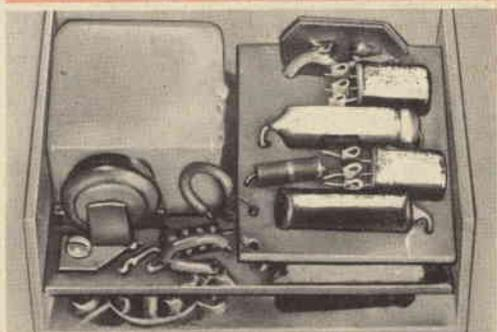
I circuiti stampati PC1 (a sinistra in alto) e PC2 (a sinistra in basso) sono fissati insieme (foto sopra) dopo aver montati su essi tutti i componenti. Il portabatteria (A e B, in basso) è tagliato da una piastra di metallo e piegato come indicato chiaramente nel testo.
