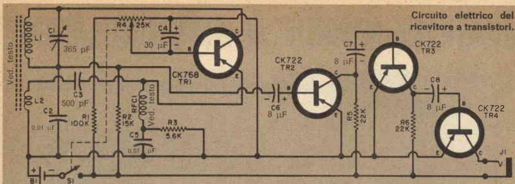
Circuito elettrico del ricevitore a transistori.
