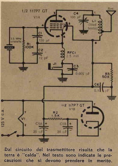
Dal circuito del trasmettitore risulta che la terra è "calda". Nel testo sono indicate le precauzioni che si devono prendere in merito.
