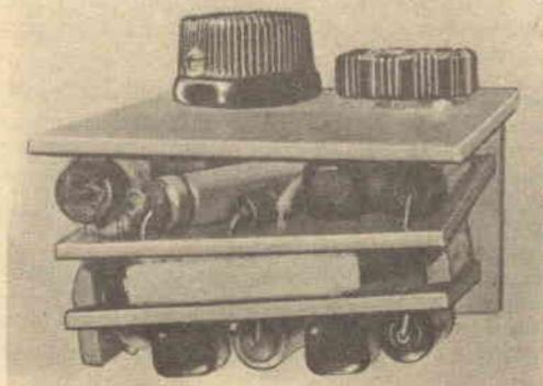
Vista laterale del ricevitore a montaggio ultimato. Notate i piccoli distanziatori di legno incollati tra le due tavolette a circuito stampato.
