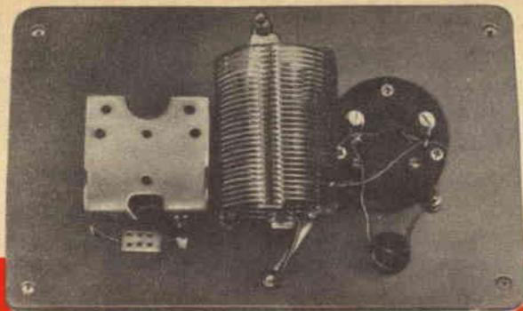
Come si vede nella foto a lato, tutti i componenti dell'ondametro sono montati sul pannello frontale. Non è visibile il collegamento all'antenna esterna (facoltativa), ma per effettuarlo basta aggiungere un condensatore da 10 pF collegandolo tra l'antenna e lo statore di C2. L'estremità superiore della bobina deve essere ancorata, come illustrato, ad un isolatore. L'ondametro si tara, come è descritto nel testo, usando un generatore che sia preciso.
