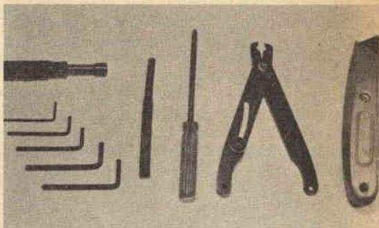
**Agli utensili base si possono aggiungere una chiave a tubo da 6 mm, una serie di chiavi Allen, un tubo per imboccare dadi, un cacciavite Phillips, una pinza spellafili ed un buon coltello.**
