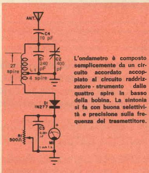
L'ondametro è composto semplicemente da un circuito accordato accoppiato al circuito raddrizzatore - strumento dalle quattro spire in basso della bobina. La sintonia si fa con buona selettività e precisione sulla frequenza del trasmettitore.
