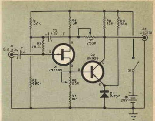
**Fig. 1** - Questo amplificatore ad alta impedenza di ingresso e con transistor ad effetto di campo, collegato ad una fonte di segnali con impedenza di 100 k $\Omega$ , ha una larghezza di banda che si estende da 1 Hz a 200 kHz.
